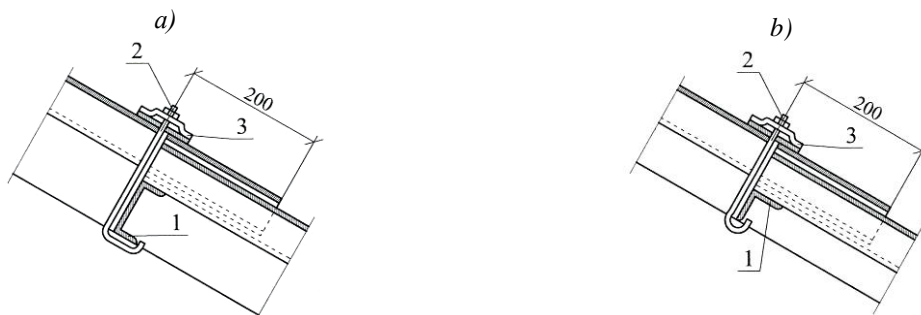
Şəkil 13.3. Xrizotilsement dam örtüyünün kompensasiya tikişi
