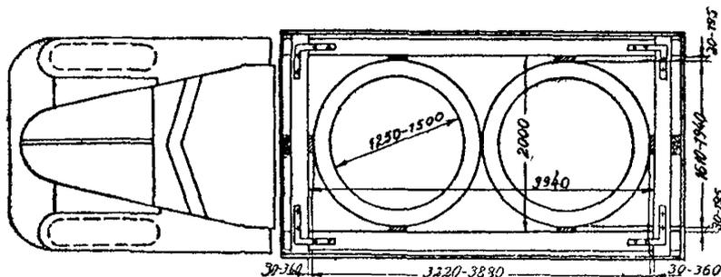
Рис. 1. Круглые звенья диаметром от 1250 до 1500 мм
