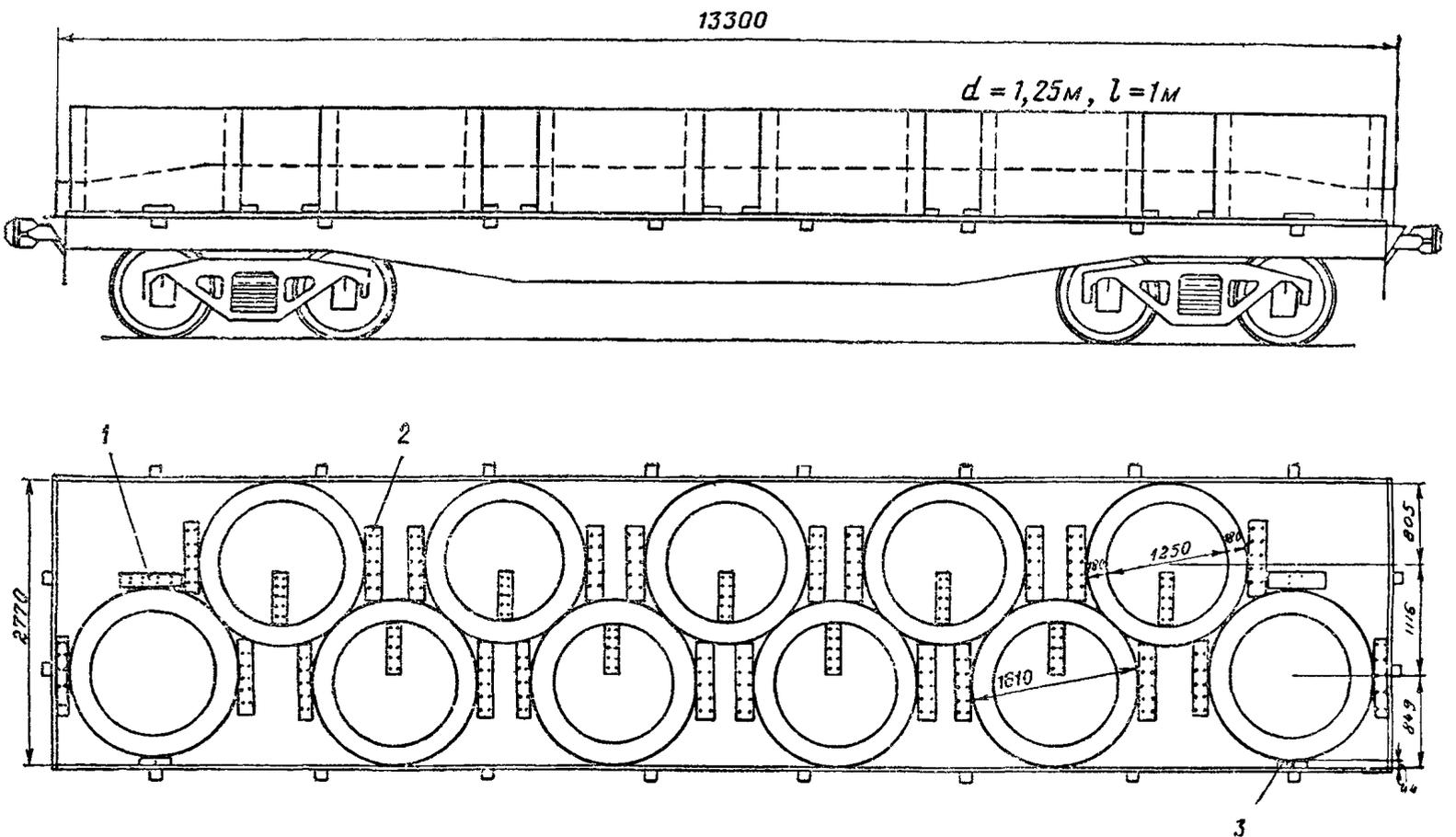
Рис. 2. Круглые звенья диаметром 1250 мм:
