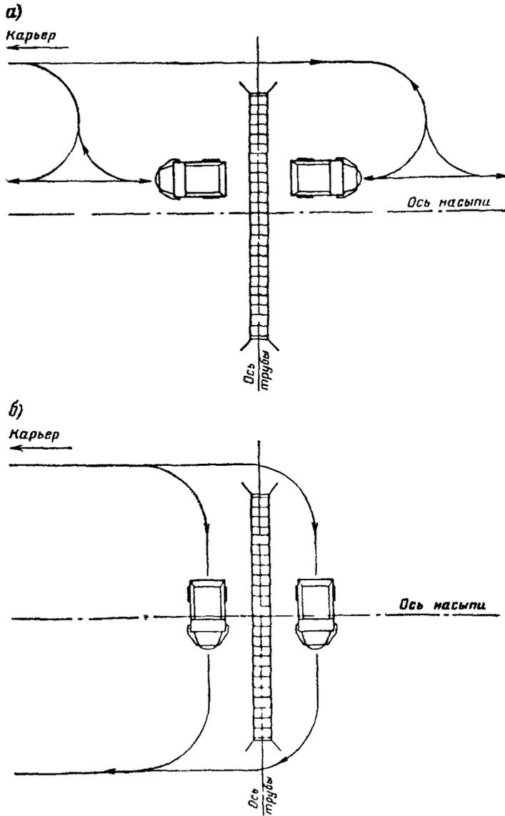
Рис. 3. Схемы движения самосвалов при засыпке труб
