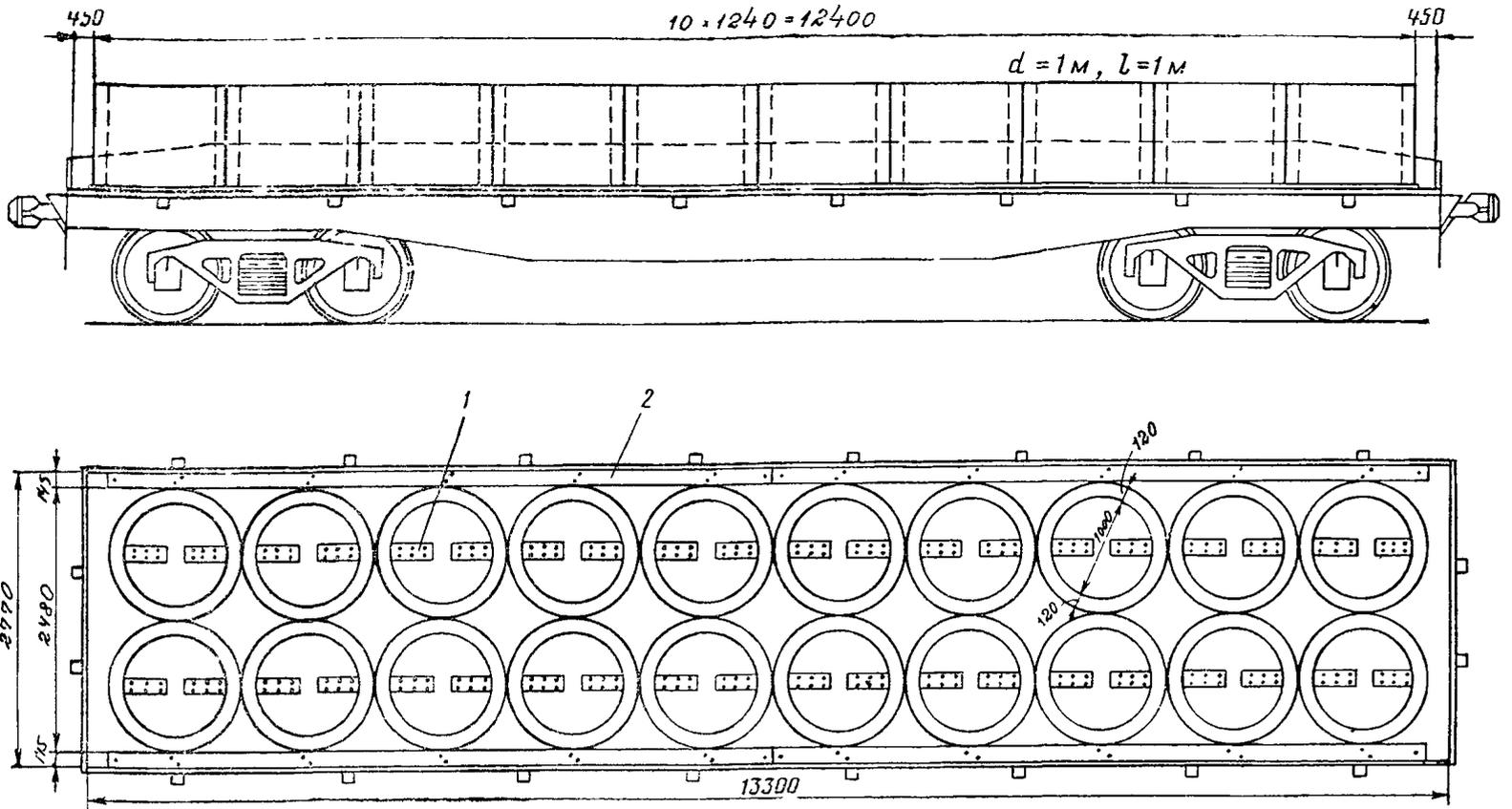
Рис. 1. Круглые звенья диаметром 1000 мм:
