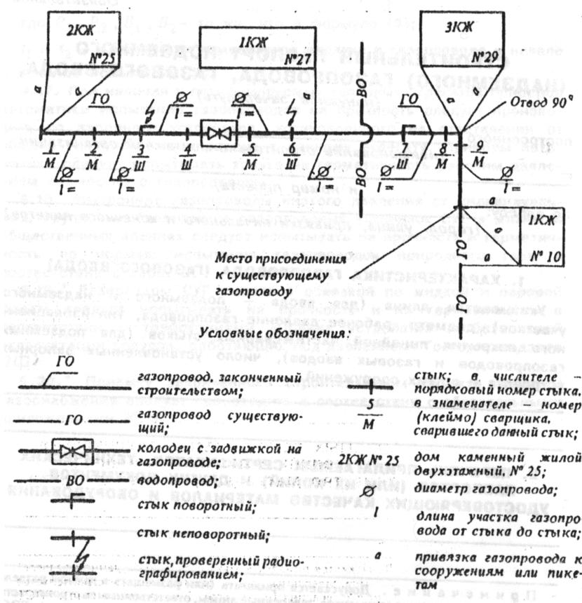
Примечание. Схема должна быть составлена так, чтобы местоположение каждого стыка могло быть найдено с поверхности земли. Для этого должны быть сделаны привязки к постоянным наземным объектам (зданиям, сооружениям) как самого газопровода, так и его характерных точек (концевых, поворотных и др.), должны быть нанесены расстояния между стыками, а также между стыками и характерными точками, в том числе пересекаемыми коммуникациями. Строгое соблюдение масштаба схемы — необязательно.
