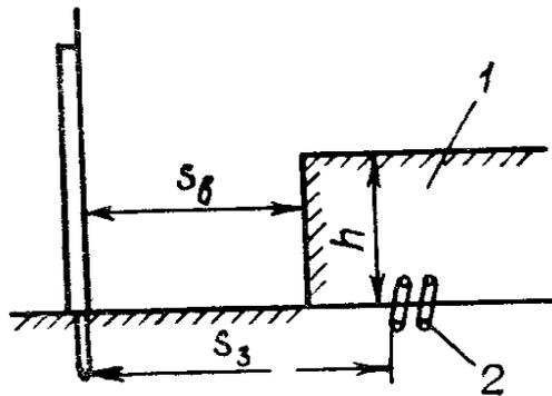
Рис. 1 – Отдельно стоящий стержневой молниеотвод:
