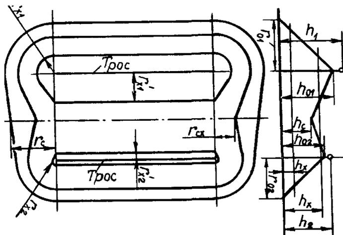
Рис. ПЗ.7. Зона защиты двух тросовых молниеотводов разной высоты
