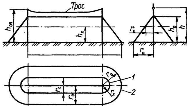
Рис. ПЗ.5. Зона защиты одиночного тросового молниеотвода.
