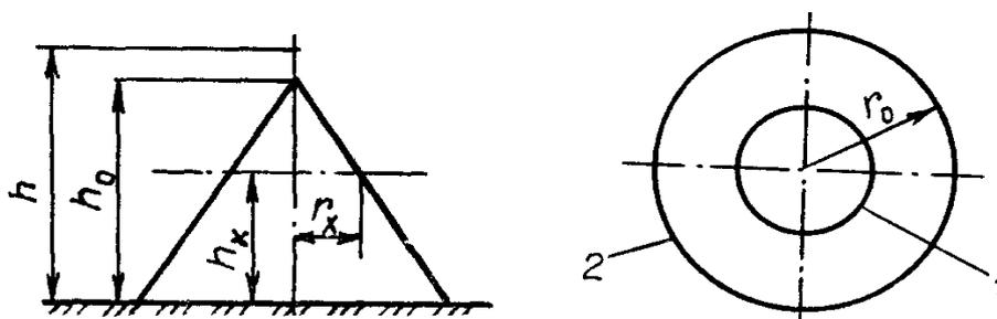
Рис ПЗ.1 Зона защиты одиночного стержневого молниеотвода:
