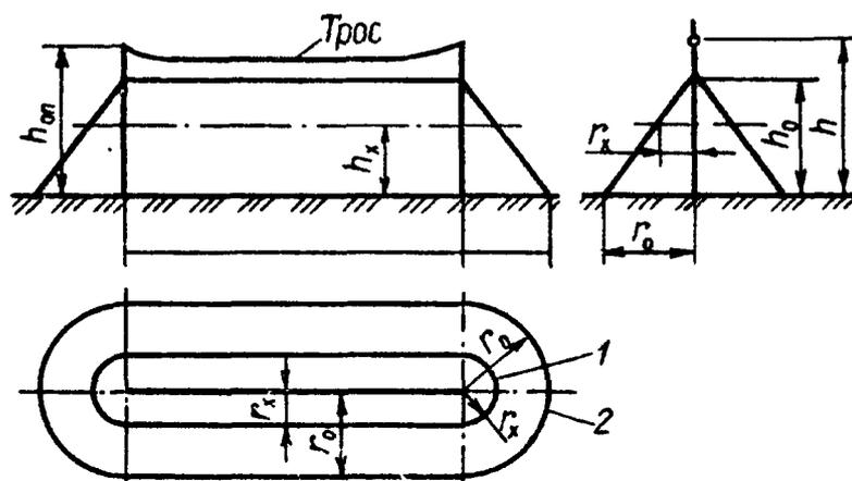
Рис. ПЗ.6. Зона защиты двойного тросового молниеотвода
