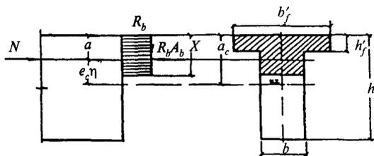
Черт. 4. Схема усилий и эпюра напряжений в сечении, нормальном к продольной оси внецентренно сжатого бетонного элемента
