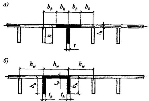
Черт. 12. Схемы расчетных сечений пластинок ортотропных плит
