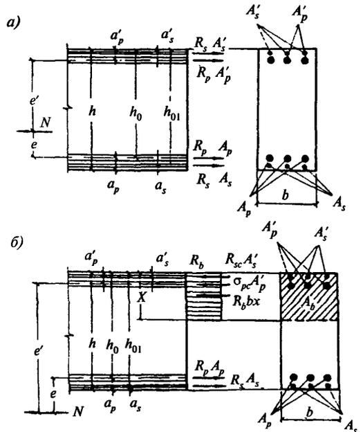
Черт. 6. Схема усилий и эпюра напряжений в сечении, нормальном к продольной оси внецентренно растянутого железобетонного элемента, при расчете его по прочности а — продольная сила  $N$  приложена между равнодействующими усилий в арматуре; б — то же, за пределами расстояния между равнодействующими усилий в арматуре
