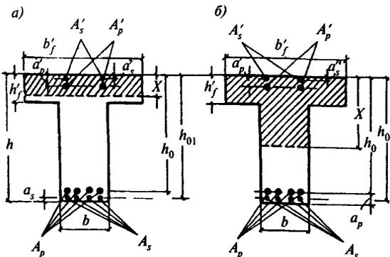
**Черт. 3.** Форма сжатой зоны в сечениях железобетонных элементов с плитой в сжатой зоне
