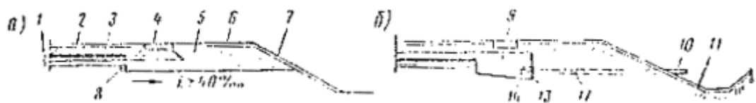
Рис. 2.6. Расположение дренажа на реконструируемых дорогах:
